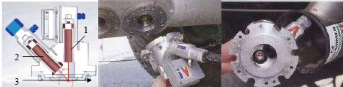
Figuur 2 Links: Schematische weergave NIRS (1: lamp, 2: sensor, 3: drijfmest stroom), Midden: in-line gemonteerd, Rechts: onderzijde sensor 4
